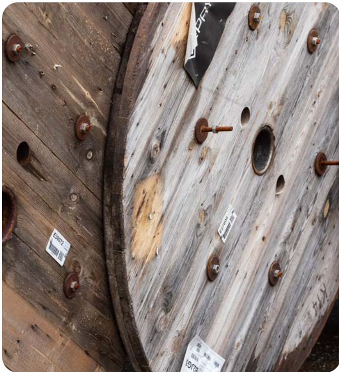
E Trumlil on metallosad defektsed või puudu.
