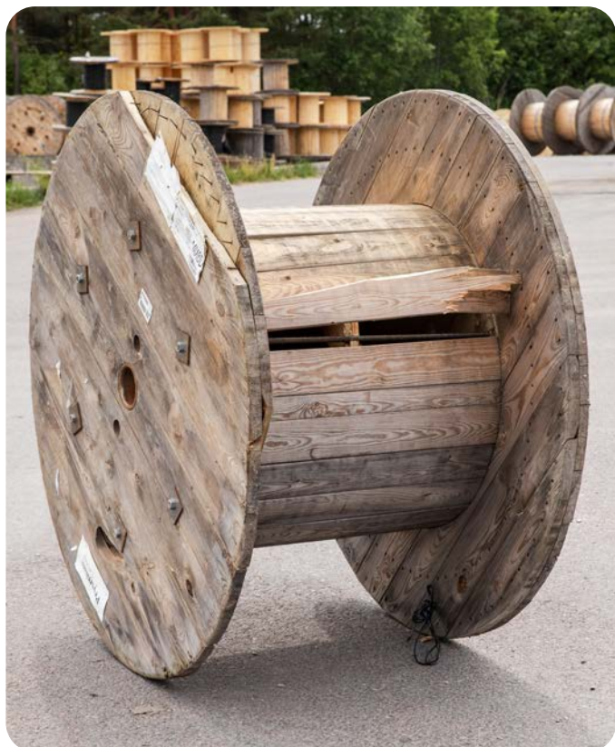
C Lauad on puudu või katki.
