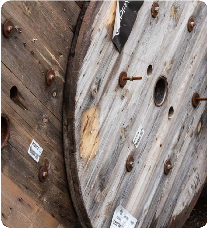
E Bojātas vai iztrūkstošas saivas metāla detaļas.
